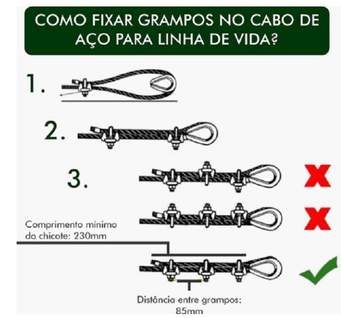
POSIÇÃO CORRETA DOS CLIPS SEM ESCALA
